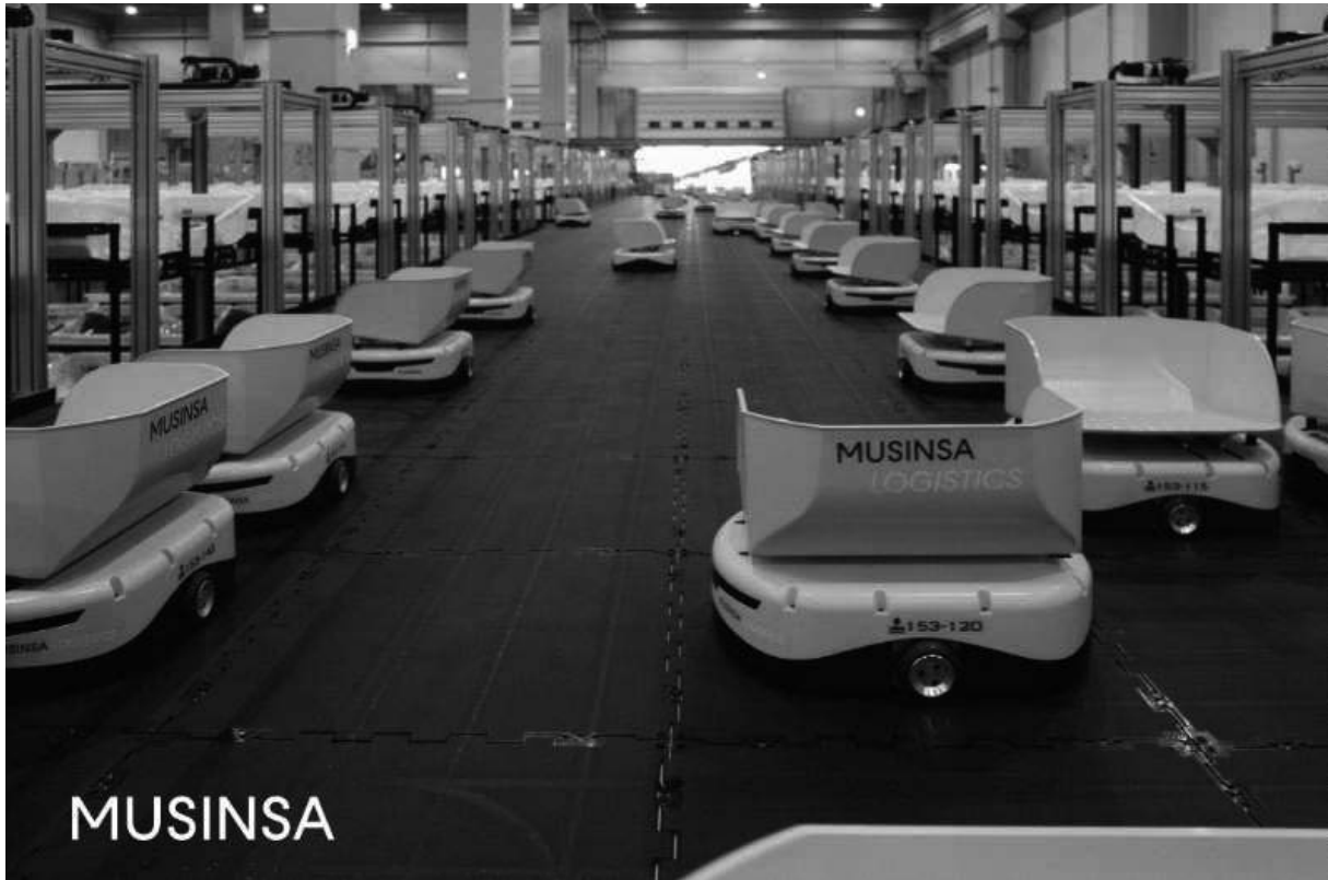
<그림 2-45> 무신사 로지스틱스가 물류센터에 도입한 ‘합포장 로봇’
